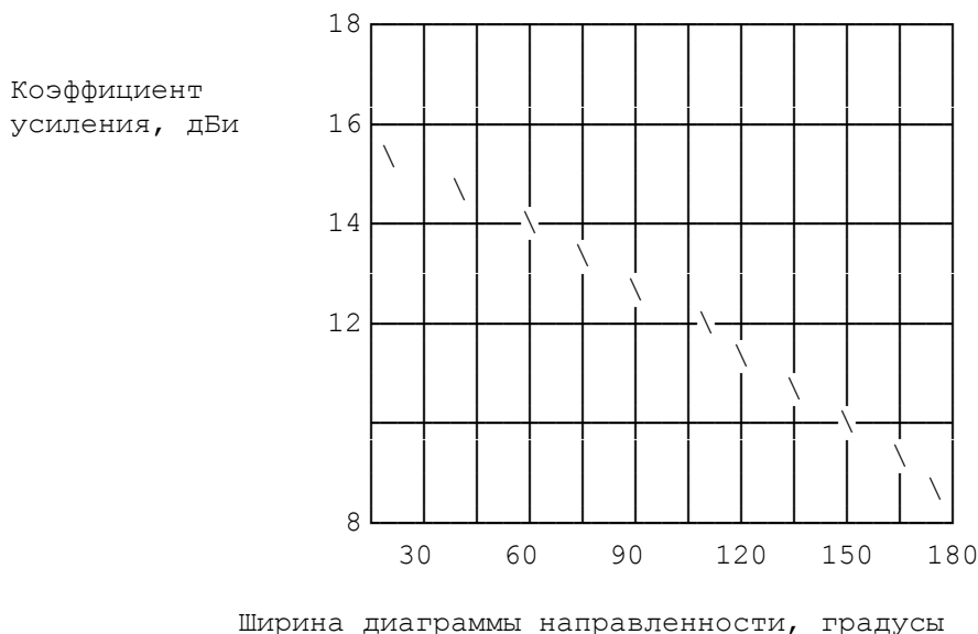
Рисунок 1. Значение коэффициента усиления для антенн базовой станции в диапазонах частот от 1 до 11 ГГц
