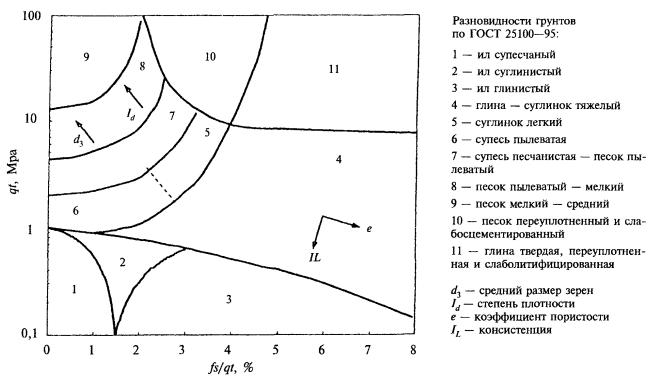
Рис. М 1. Разновидности грунтов по данным СРТ согласно ГОСТ 25100-95. Стрелками указано направление увеличения величины параметров
