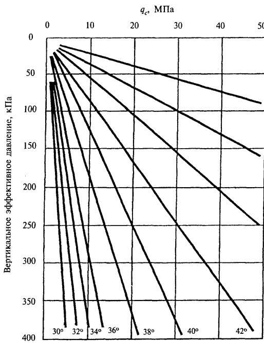
Рис. М 2. Номограмма определения угла внутреннего трения песков по СРТ
