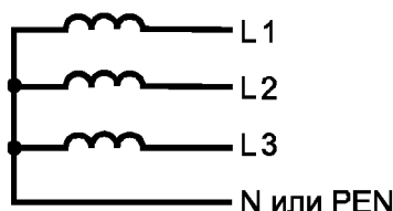
Рисунок 5. Трехфазная четырехпроводная электрическая цепь
